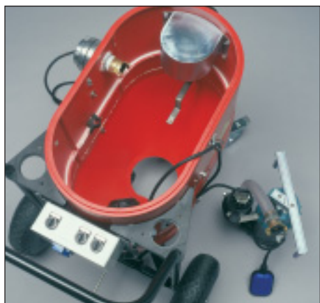
Démontage facile de la pompe avec trappe ouverte pour nettoyage général.
