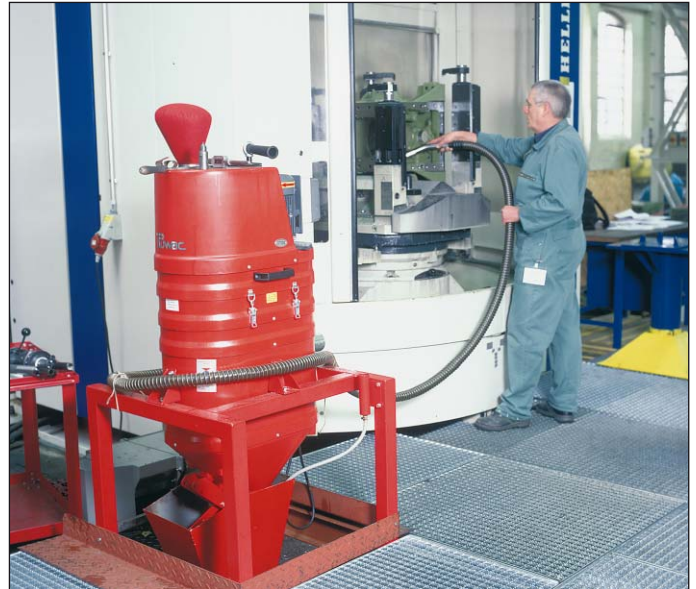
DS 1220 en aspirateur sur silo lors pour le nettoyage de machines
